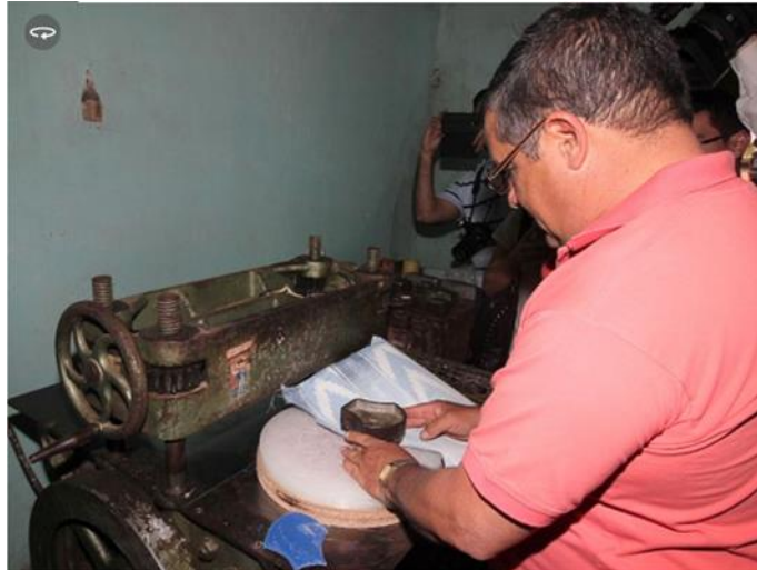
Figura 2. Corte con maquina semi-automática “Barandil”. Fuente: Baruja Yambay, 2016).
