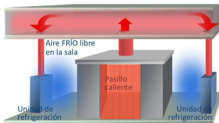
Figura 2: Sistema de contención de pasillos calientes (HACS) implementado con sistemas de refrigeración en filas
