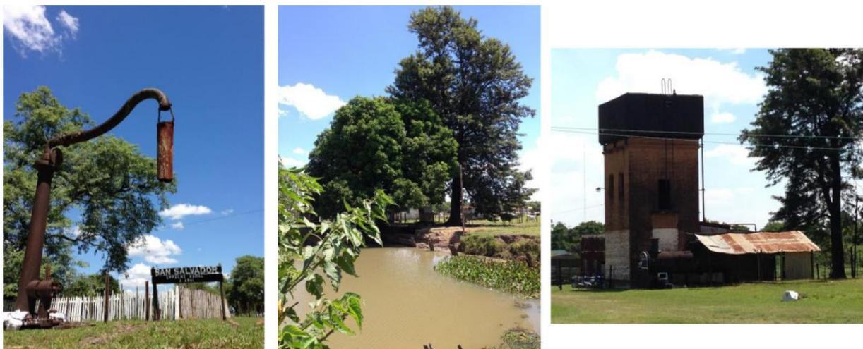
Los depósitos de agua del ferrocarril fueron un elemento imprescindible para la explotación ferroviaria en los tiempos del vapor; muchos aún se ven en la entrada de algunas estaciones.
